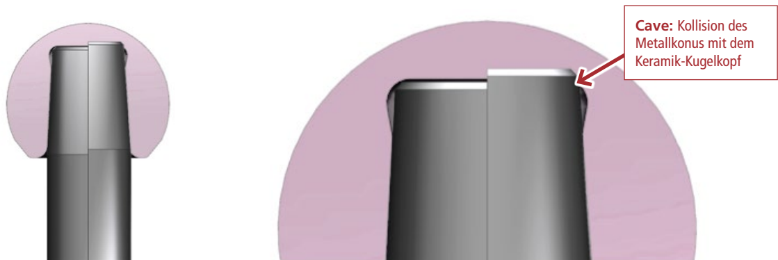
Abb. 4: Kompatibilitätsbeispiel: Designunterschied zweier nominell gleicher 12/14-Konen, dargestellt am Formschluss mit einem Keramik-Kugelkopf
