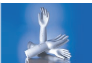
Keramik-Tauchformen für die Handschuh-Herstellung
