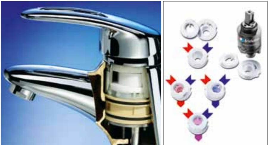
Schmiermittel aufnehmen können. Sie bilden dafür ein dauerhaftes Reservoir – selbst nach zwei Millionen Betätigungszyklen unter realen Betriebsbedingungen konnten noch ausreichende Fettreste nachgewiesen werden. Überdies nehmen die Poren auch Feststoffpartikel auf, die mit dem Wasser mitgeführt werden, und vermindern dadurch ebenfalls den Verschleiß; die meisten dieser Teilchen werden allerdings zwischen den beiden Scheiben zerrieben und so unschädlich gemacht.
