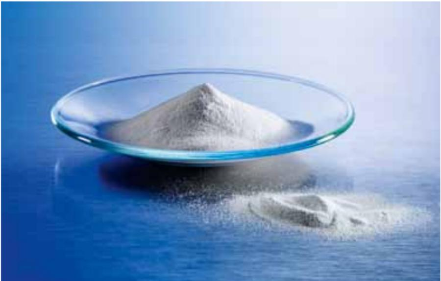
ser betragen 50 bis maximal 150  $\mu\text{m}$ . Aufgrund ihrer Kugelform verhalten sich die Granulate beim Befüllen der Werkzeugformen deutlich besser als der reine Rohstoff. Sie rieseln ähnlich gut wie trockener, feiner Sand und können so auch automatisch dosiert werden.
