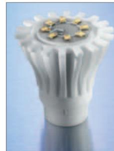
Multi-LED Chips arbeiten mit hohen Leistungsdichten. Hier ist Keramik optimal. Bei 150mW/mm² und MC-PCB reduziert ein Alunitsubstrat den Wärmewiderstand von 15K auf 2K. Er wird nahezu vernachlässigbar.
