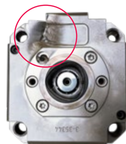
Werkzeugaufnahme ohne Verschleißschutz
